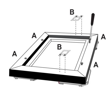
3 Den Rahmen mit den Halte-Haken mit den mitgelieferten Schrauben an der Fotoleinwand fixieren.
